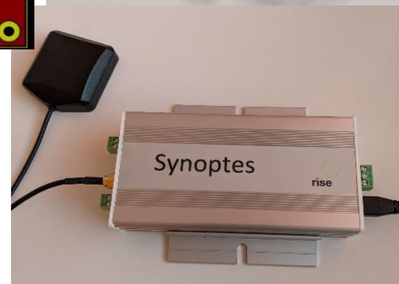
Ceas absolut bazat pe prelucrarea de semnal GNSS acuratețe < 1 microsecundă
