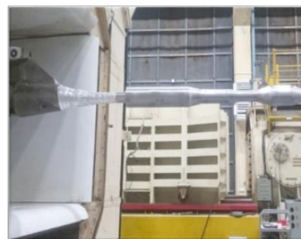
Teste machetă în sufleria trisonică, INCAS București
